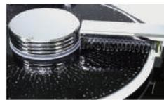
特に③の吸い上げる瞬間は盤面において強力な流水が発生するため、音溝深くのカビ・微細な塵までも吸い上げることができ、非常に効果的なクリーニングを実現しています。
