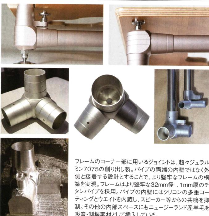
フレームのコーナー部に用いるジョイントは、超タジュラルミニ7075の削り出し製。パイプの両端の内壁ではなく外側と接着する設計とすることで、より堅牢なフレームの構築を実現。フレームはより堅牢な32mm径、1mm厚のチタンパイプを採用。パイプの内壁にはシリコンの多重コティングとウエイトを内蔵し、スピーカー等からの共鳴を抑制。その他の内部スペースにもニュージーランド産羊毛を吸音・制振素材として挿入している。
