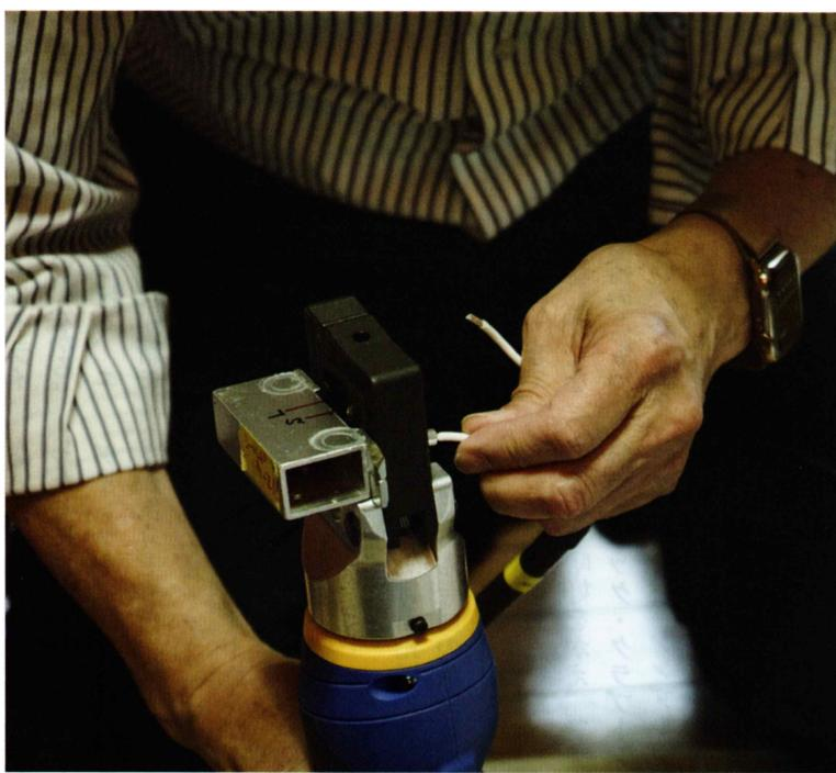
「コードオーミック」処理の音質効果を確認するため、ハンダ付けした端子をその場で圧着つけかえて比較試聴を行った
