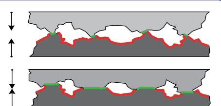
抜き差しの前（上段）、後（下段）の比較イメージ
