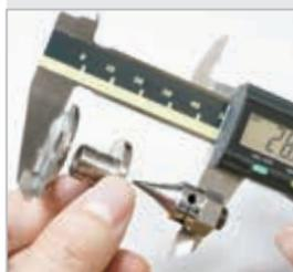
棚板用のスパイクと、それを受け止める「トップマウント」は、1000 個ほどの中からデジタルノギスを用いて 0.01mm の精度で高さの合う 4 個をマッチングし、各段ごとに(混ぜずに)使用します。歪みのない設置を追求する上で、欠かせないポイントです。
