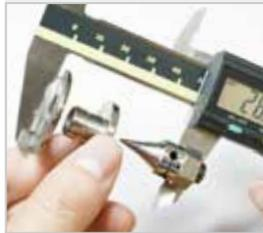
棚板用のスパイクと、それを受け止める「トップマウント」は、1000個ほどの中からデジタルノギスを用いて±0.01mmの精度で高さの合う4個をマッチングし、各段ごとに(混ぜずに)使用します。歪みのない設置を追求する上で、欠かせないポイントです。
