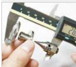
棚板用のスパイクと、それを受け止める「トップマウント」は、1000個ほどの中からデジタルノギスを用いて±0.01mmの精度で高さの合う4個をマッチングし、各段ごとに(混ぜずに)使用します。歪みのない設置を追求する上で、欠かせないポイントです。
