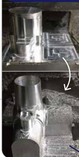
パイプフレーム構造では、各パイプを繋ぐジョイント部に最も強度が要求されます。堅牢・軽量を追求し、「コーナージョイント」には超々ジュラルミンA7075を採用。CNCによる精密切削で、1個あたり6時間かけて丁寧に製作しています。
